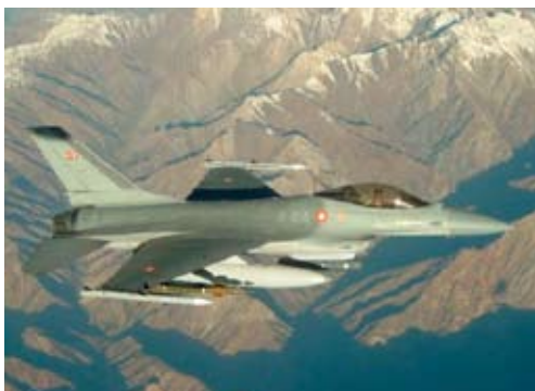
F-16 med en LANTIRN monteret på undersiden af den forreste del af indsugningen – den mørkegrå cylinderformet genstand. Under vingen ses også en laser guidede bombe, hvilket kan ses af laserhovedet forrest på bomben.
