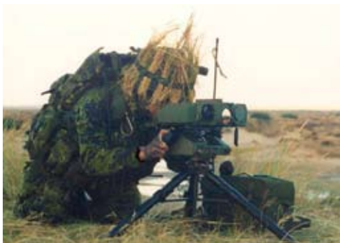
FAC som laser en bombe ind i målet ved hjælp af sin GLTD. Laseren kan række 20 km og er så kraftig at den kan forårsage brandsår og blindhed.
