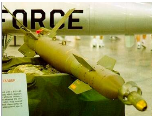
Laser styret bombe, hvilket kan ses på søgehovedet forrest på bomben. Bomben kan styres mod målet både af piloten ved brug af hans laser i hans POD eller af FAC ved brug af en Ground Laser Target Designator (GLTD).
