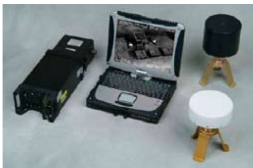
ROVER systemet består af en laptop og en antenne samt en boks til at modtage det signal som POD'en sender på.
