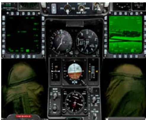
Billede af cockpittet i et jagerfly. Over højre knæ på piloten ses den 7" skærm som piloten ser sit billede i.
