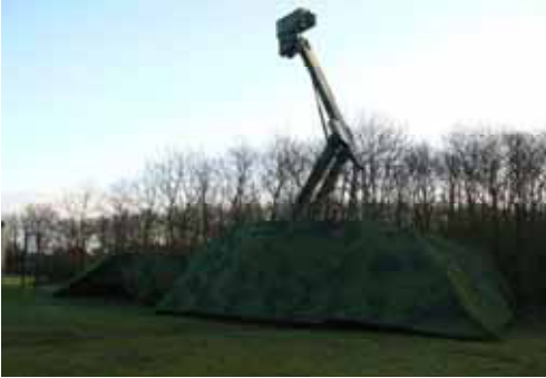
Sløret søgeradar fra Kontrol- & Varslingsbatteriet.
