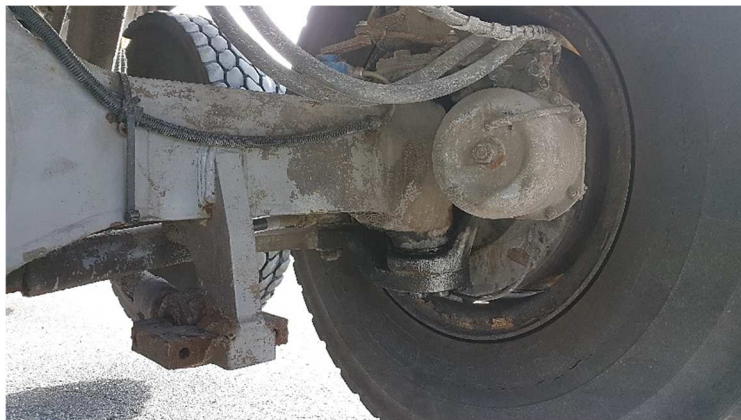
Besiktiget undervogn. Noe rust og litt små skader i dekk. Ingen oljeflekker etter testen.
