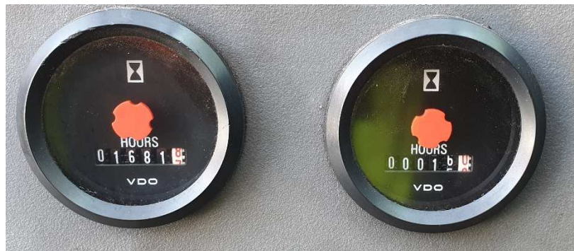
Winch timer på hovedwinch =1681 og ekstra winch=16
