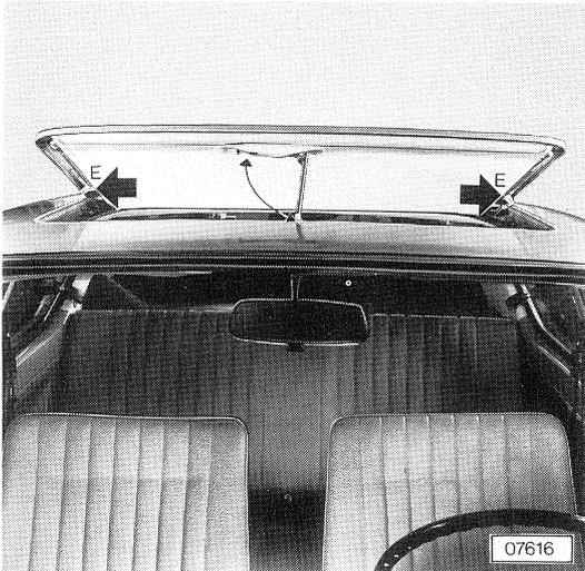
Darauf achten, daß vor dem Einlegen des Schiebedaches in die Dachöffnung die beiden Stützhebel "E" nach außen zeigen.
