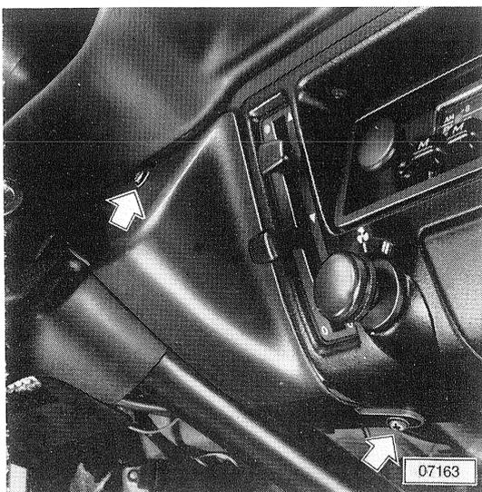
Rechtes Teil der Schalterleiste sowie Schaltergehäuse ausbauen. Hierzu 2 Schrauben an der rechten Schalterleiste und
