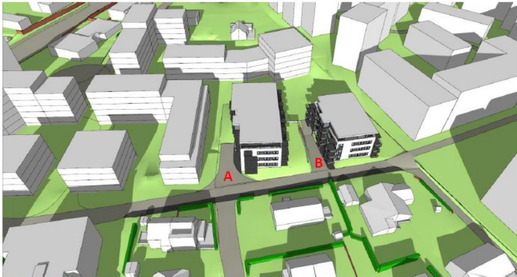
Figur 11 A: Snuhammer og oppstilling for renovasjonsbil (til venstre) og B: Innkjørsel til P-kjellere (til høyre)
