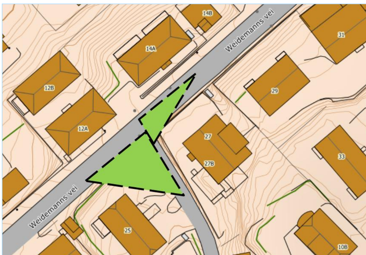
Figur 27 Skisserte sikttrekanter i krysset Weidemanns vei X Sigurd Bergs allé med dagens uregulerte T-kryss
