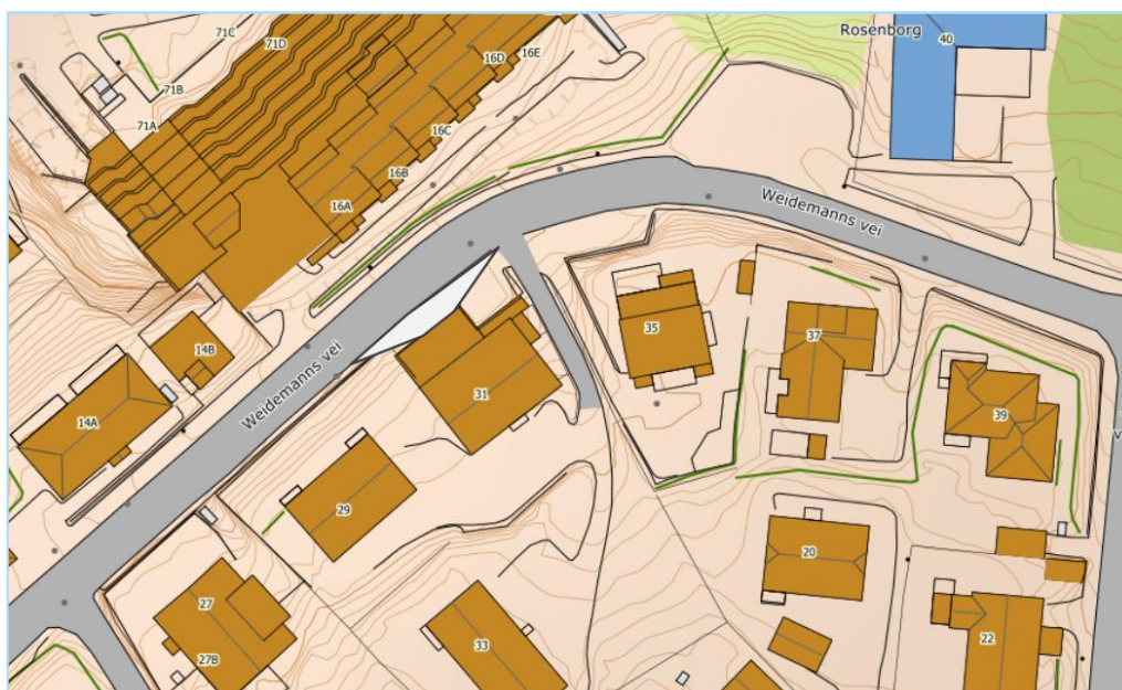
Figur 29 Mulig løsning med ensidig fortau og lomme for renovasjonskjøretøy
