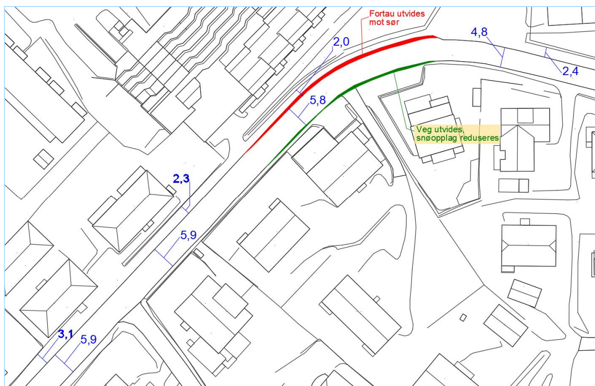
Figur 23 Forslag til geometri med ensidig fortau
