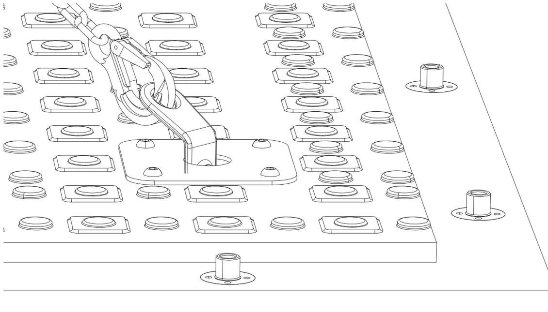
Durch Anheben des Kettengehänges kann die Platte in die gewünschte Position bewegt und verlegt werden.
