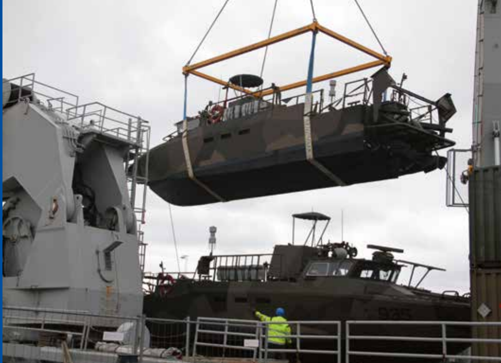
Specialtillverkade balkar gjorde att båtarna passade perfekt.
