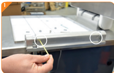
Stap 2: Draai de inbusschroeven aan beide zijden los.
