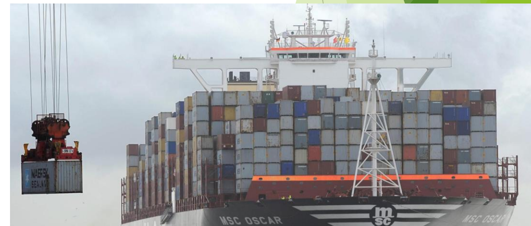
Das Containerschiff mit der bisher weltweit größten Tragfähigkeit, die „MSC Oscar“, ist 395 Meter lang, 59 Meter breit und hat Platz für 19.224 Standardcontainer
