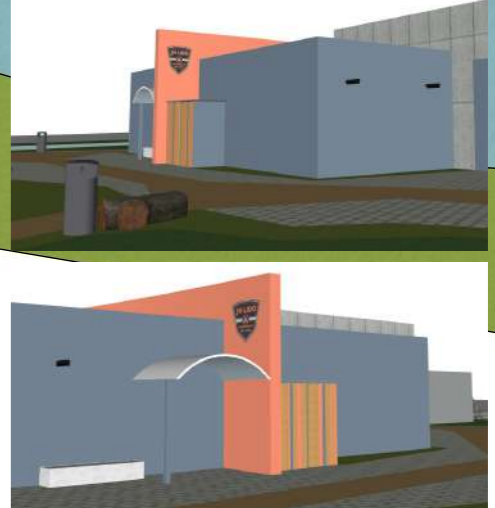
Houten bergmuur met groendakje voor afvalbakken aan JH Lido. Houten latten van diverse breedtes.
