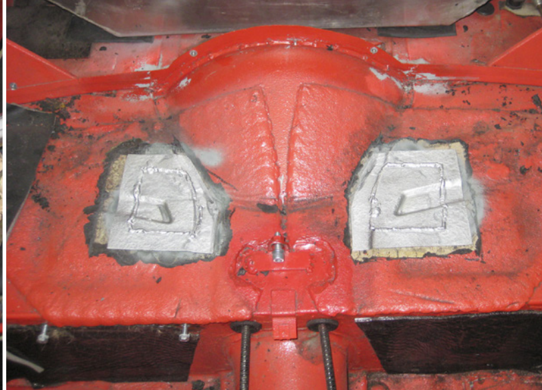
Förstärkningar på ovansidan baktill så som Inge Jonsson gjorde på sin TR6
