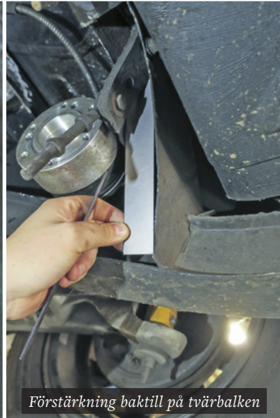
Förstärkningar på ovansidan baktill så som Inge Jonsson gjorde på sin TR6
