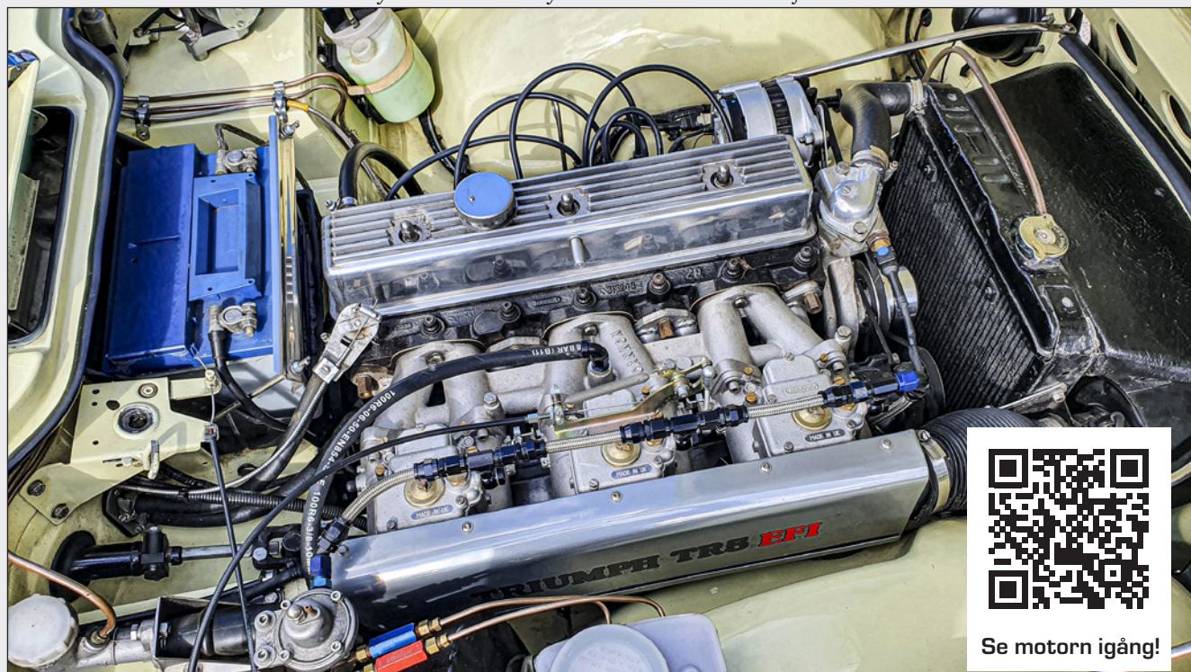
Harrys motor med Jenvey Throttle bodies i "Weberutförande"
