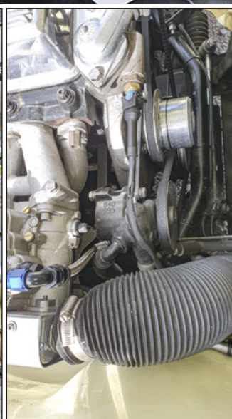
Sensors för kylvätskans temperatur samt Crank position sensor
