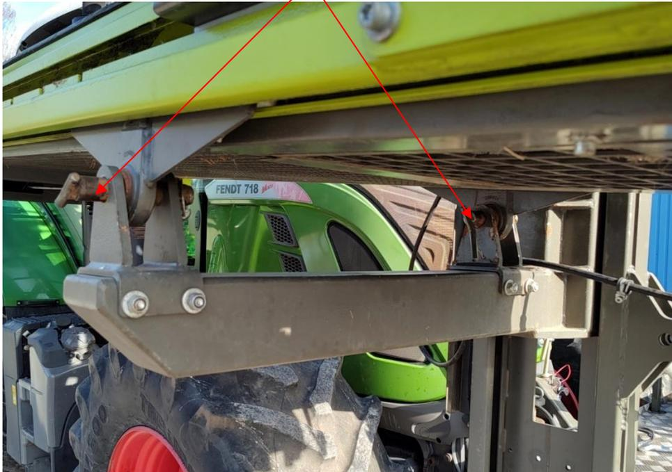
b. Heben Sie die Maschine an, bis sie waagrecht steht, und öffnen Sie die Sicherheitsverriegelung, damit der Haken abgenommen werden kann.
