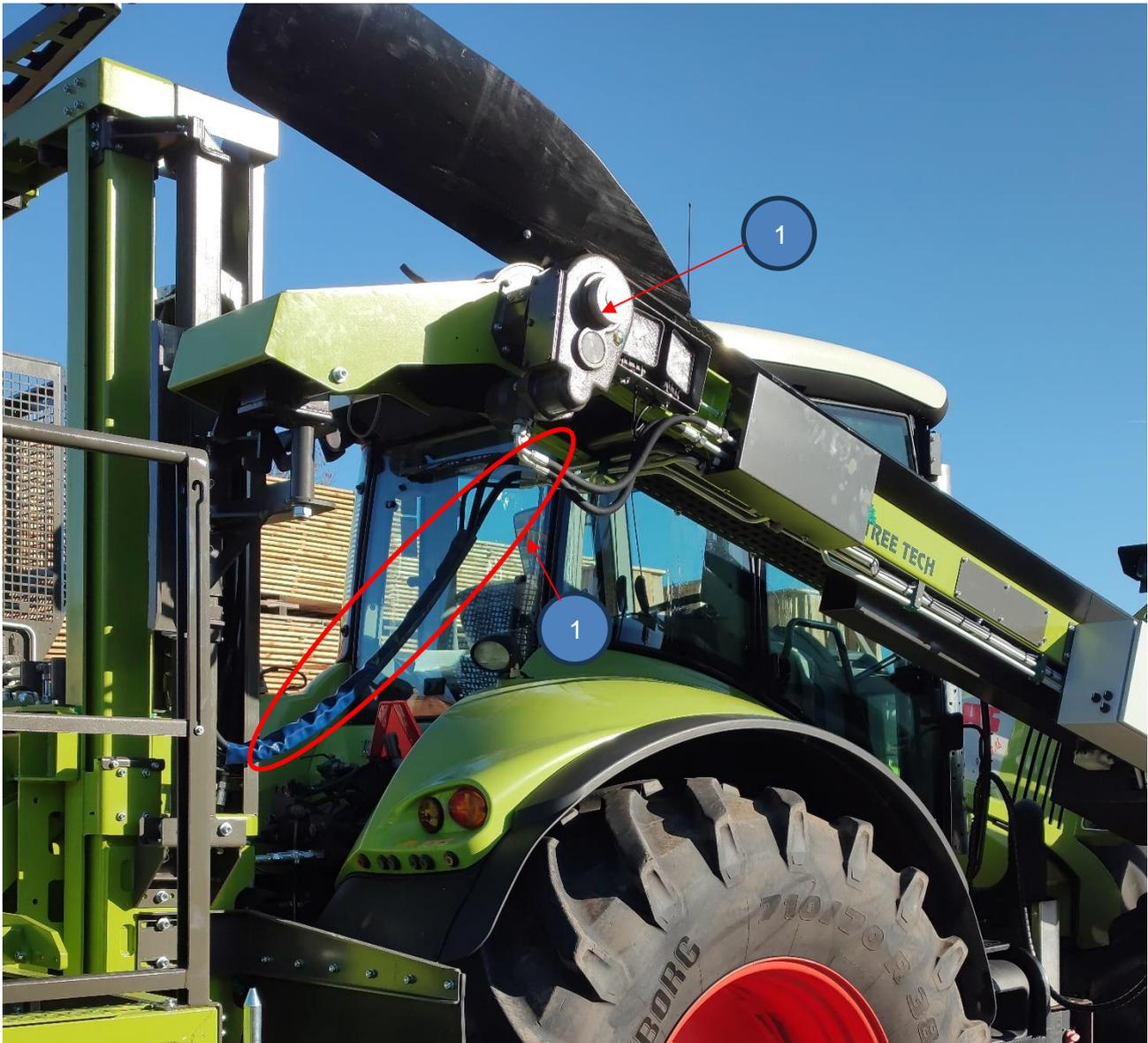
1. Hydraulische Abgänge von der Verpackungsmaschine zur Netzmaschine
