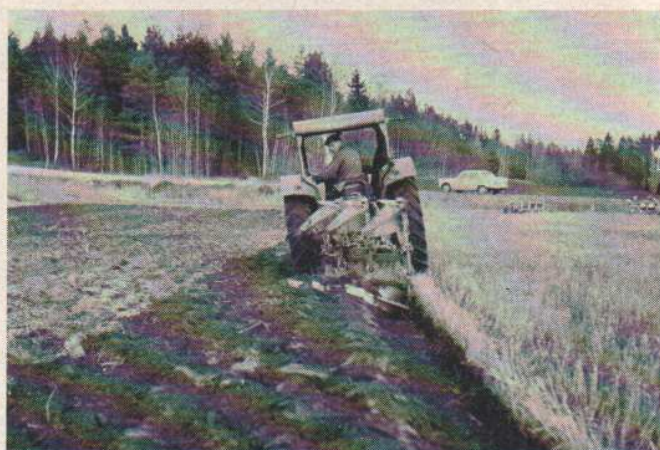
8. Överums växelplog i arbete. Inga ryggar eller slutfåror behöver göras — traktorn körs tillbaka i den sist plöjda fåran.
