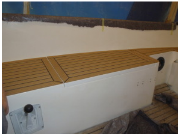
En lille detalje. Læg mærke til den nye kistebænklåge med en kant foran. Intet af træ, intet der rådner.
