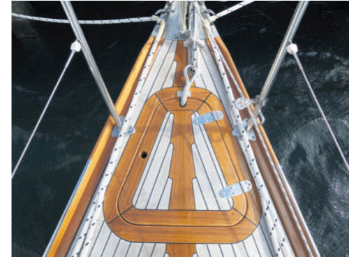
■ I første omgang lagde Poul Tom Hansen nyt teakdæk og lavede ankerbrønd uden lakeret ramme og uden lakeret fisk (= den savtaktede, langsgående midterplanke). Lakeringen er siden kommet til og danner en klædelig kontrast til det nu sølvgrå teakdæk. Foto: Søren Stidsholt Nielsen
