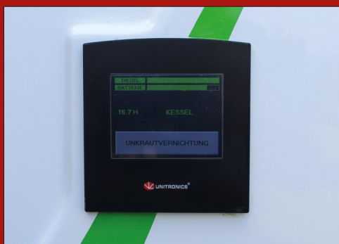
Med den elektroniske styring opnås enkel og sikker betjening og resterende batteri og diesel kapacitet kan overvåges
