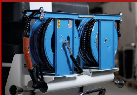
Systemet har stor kapacitet og kan som tilvalg monteres med to slangeruller, så flere personer kan benytte det samtidig
