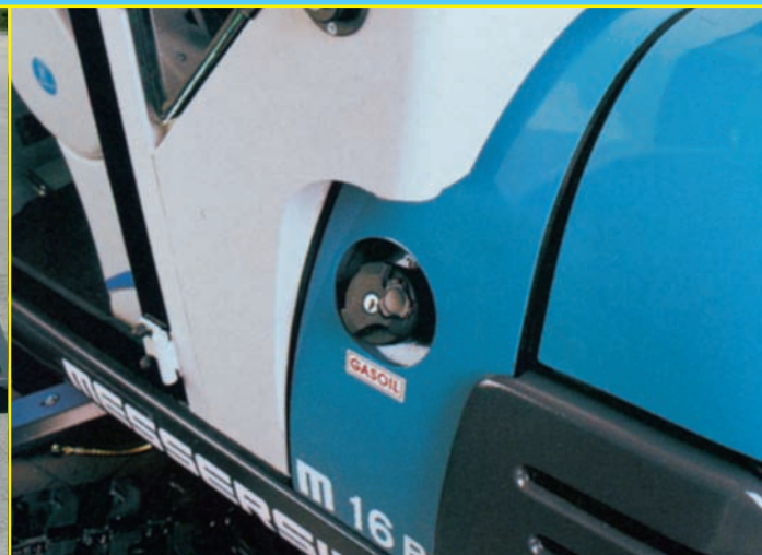
Il rifornimento di gasolio è accessibile dall'esterno della macchina / Le ravitaillement de carburant est accessible de l'extérieur de la machine / Se accede al tanque de gasóleo desde el exterior de la máquina
