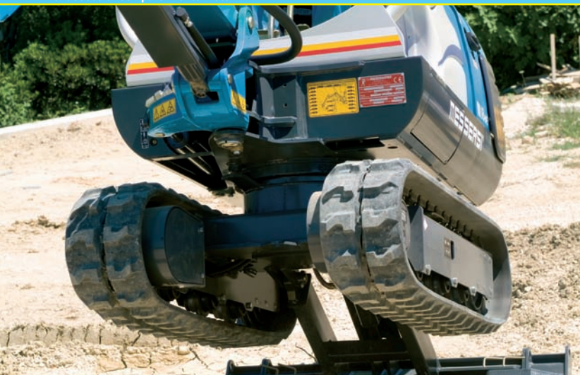
Allargamento idraulico della carreggiata da mm 1000 a mm 1300 (solo M-18 BE), con conseguente adeguamento manuale della lama reinterro alla nuova larghezza / Élargissement hydraulique de la chaussée de 1000 mm à 1300 mm (seulement M-18BE), et de conséquence, ajustement manuel de la lame niveleuse à la nouvelle largeur / Ancho de vía extensible de forma hidráulica de mm 1000 a mm 1300 (sólo M-18 BE), y consiguiente ajuste manual de la cuchilla reinterro al ancho nuevo
