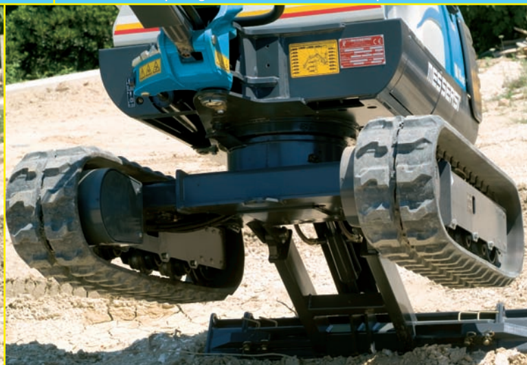
Allargamento idraulico della carreggiata da mm 1000 a mm 1300 (solo M-18 BE), con conseguente adeguamento manuale della lama reinterro alla nuova larghezza / Élargissement hydraulique de la chaussée de 1000 mm à 1300 mm (seulement M-18BE), et de conséquence, ajustement manuel de la lame niveleuse à la nouvelle largeur / Ancho de vía extensible de forma hidráulica de mm 1000 a mm 1300 (sólo M-18 BE), y consiguiente ajuste manual de la cuchilla reinterro al ancho nuevo
