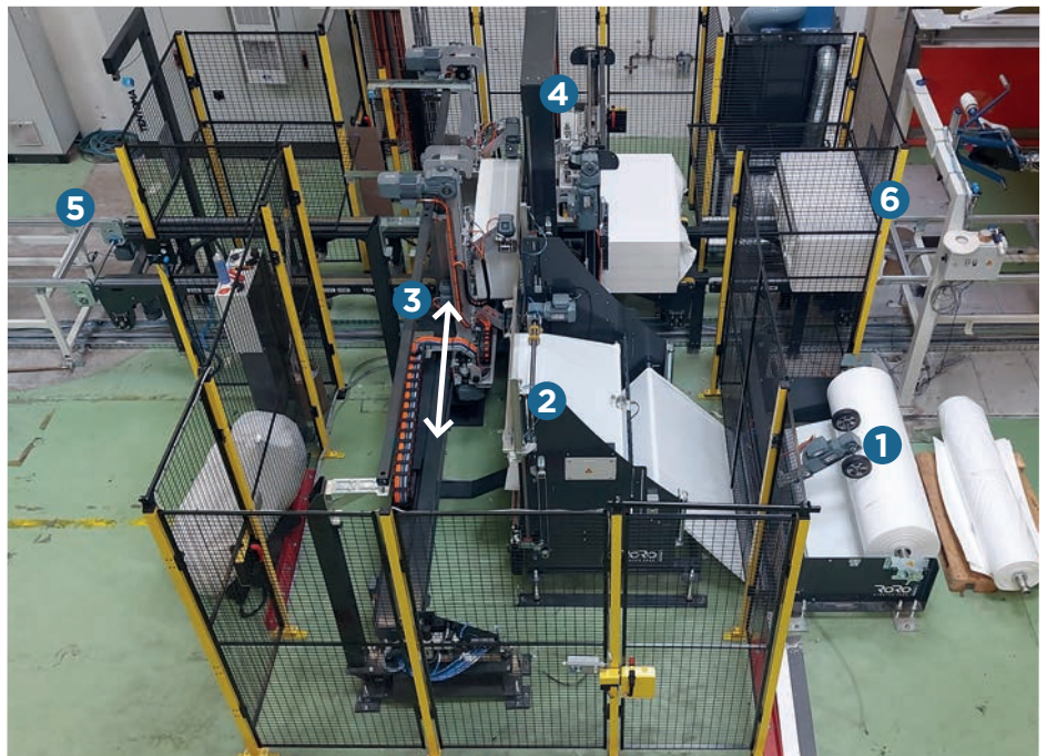
Blick auf die neue RoRo StretchPack® Inline-Verpackungslinie bei Steinbacher.
