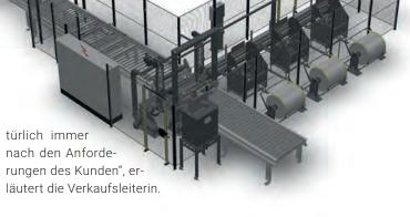
Die neue Technologie basiert auf der bewährten vertikalen Haubenstretchverpackung von z.B. Paletten. Tentoma hat diese Technologie weiterentwickelt, so dass sie in der Lage ist, eine horizontale sechsseitig versiegelte Verpackung in nur einem Arbeitsschritt zu realisieren. Sie eignet sich insbesondere für die Verpackung von großen Gütern wie Türen, Tischplatten und ähnlichen Objekten.
