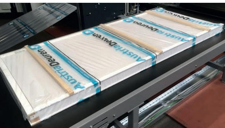
Die schlauchförmige Stretchfolie ist bedruckbar und eignet sich zum Branding und für Produktinformationen.
