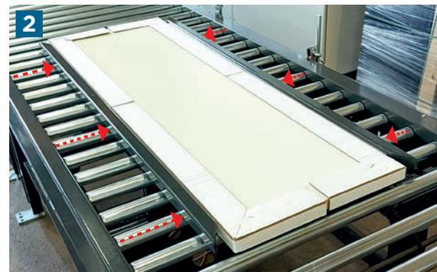
Vor dem Verpacken wird die Tür mittig ausgerichtet. Während die Tür zentriert wird, werden Breite und Höhe gemessen. Die Abmessungen werden verwendet, um die richtige Foliengröße für den Verpackungsprozess vorzubereiten.
