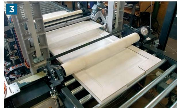
Mit RoRo StretchPack® wird die Tür in einer schlauchförmigen Stretchfolie verpackt. Der Folienschlauch wird während der Verpackung an beiden Enden versiegelt, um eine hundertprozentige Versiegelung zu gewährleisten.
