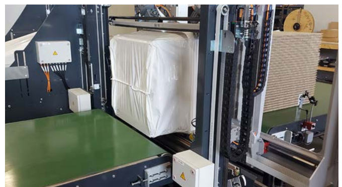
Horizontale Verpackung von Dielen in einer schlauchförmigen Stretchfolie mit RoRo StretchPack®.
