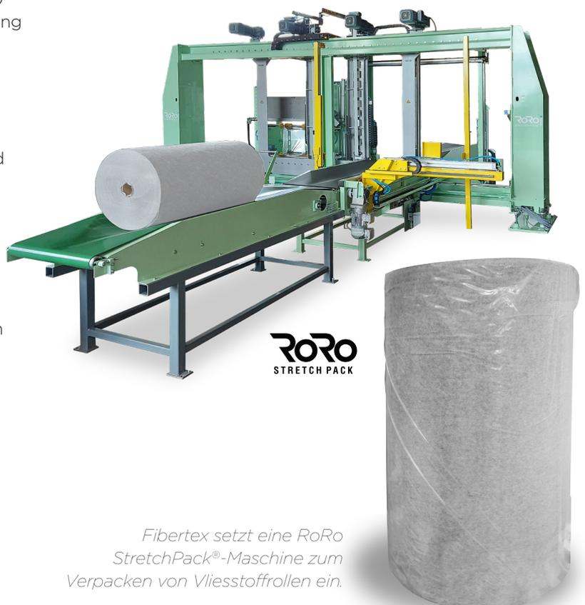
Fibertex setzt eine RoRo StretchPack®-Maschine zum Verpacken von Vliesstoffrollen ein.
