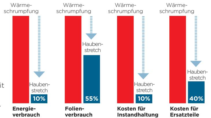
Wenn Sie das Wärmeschrumpfsystem aus der Produktionslinie entfernen, können Sie die Betriebskosten erheblich senken. Die dargestellten Einsparungen basieren auf einem spezifischen Kundenfall.
