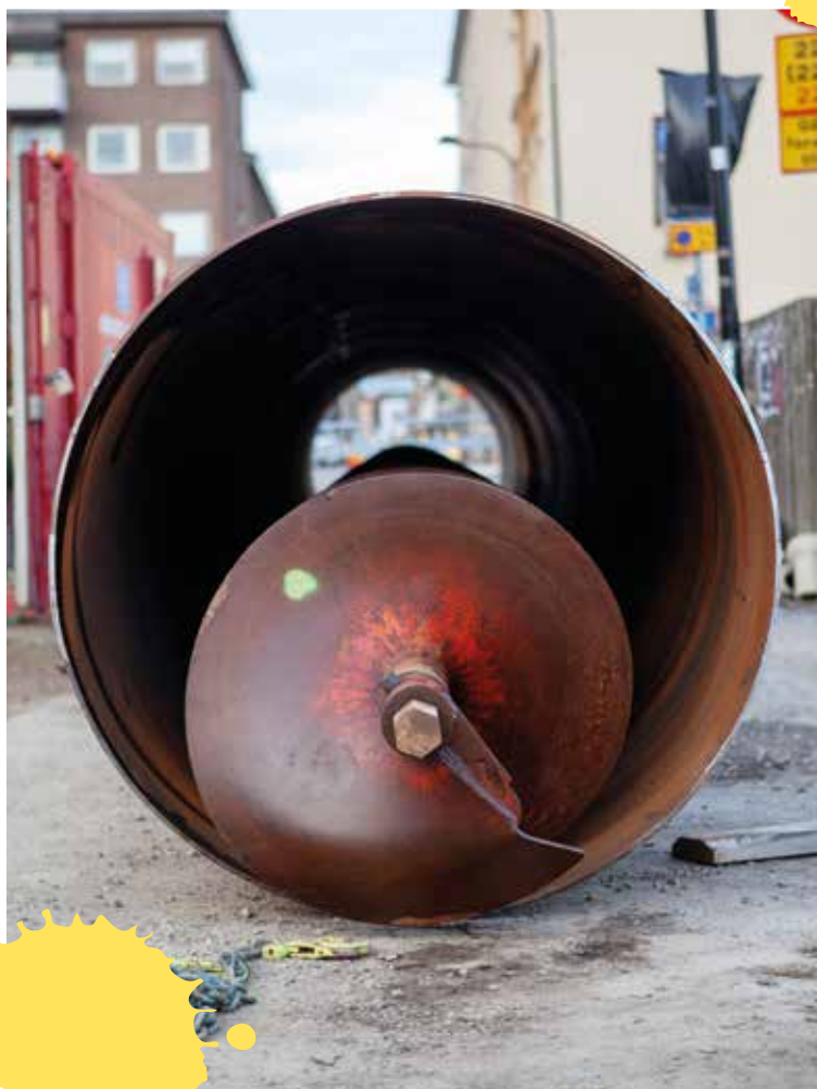
Den spiralformade skruvborren roteras inne i stålroret.
