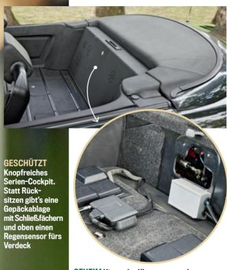
**GEHEIM** Hinter der Klappe versteckt: SGS-Computersteuerung im silbergrauen Kasten, darüber Hochdruck-Hydraulik der Firma Power-Packer
