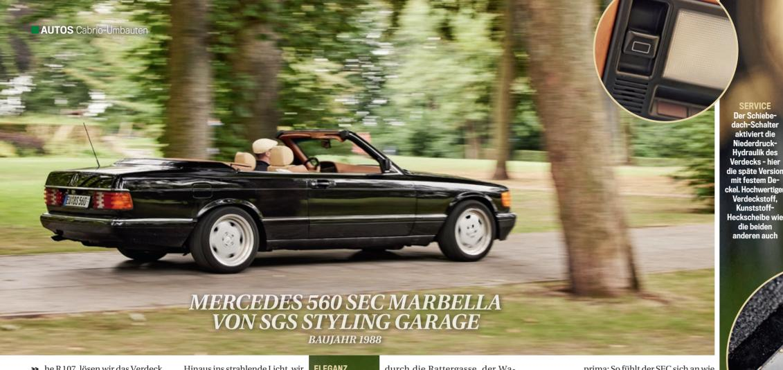
>> he R 107, lösen wir das Verdeck vorn am Scheibenrahmen. Oben am Schiebedachschalter ziehen, und daraufhin hebt sich der Deckel aus GFK vom Verdeckkasten, das Dach surrt mit der Melodie von Elektromotor, Hydraulikpumpe und fünf Hydraulikzylindern ins Körbchen.
