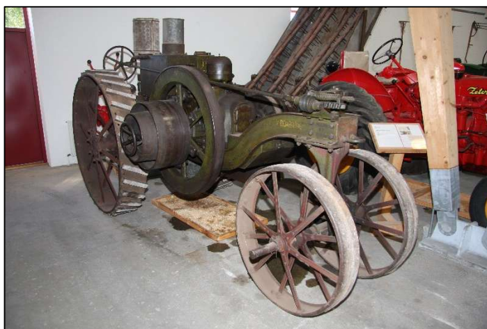
Amerikansk traktor af mærket "Mogul". Den kunne bruges til såvel markarbejde som til ved remtræk at trække fx et tærskværk. Traktoren står på Gl. Estrup
