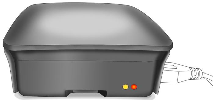
1. Blinkt schnell (300ms an, 300ms aus): Wartet auf Verbindung mit dem SoundEar®3 Gerät
