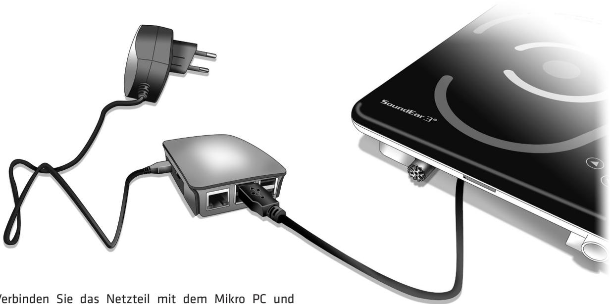
2. Verbinden Sie das Netzteil mit dem Mikro PC und stecken Sie den Adapter in die Steckdose. Der Mikro PC versorgt SoundEar®3 mit Strom.
