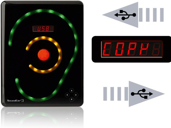
1. Verbinden Sie den USB-Schlüssel mit dem SoundEar®3 Gerät. Die Worte „USB“ gefolgt von „Copy“ erscheinen im Mini-Display. Zählend von 0 bis 100, zeigt das Mini-Display den Stand des Exportes auf den USB-Schlüssel. Der Prozess kann von wenigen Sekunden bis zu einer Minute dauern, abhängig von der Größe der internen Log-Datei.
