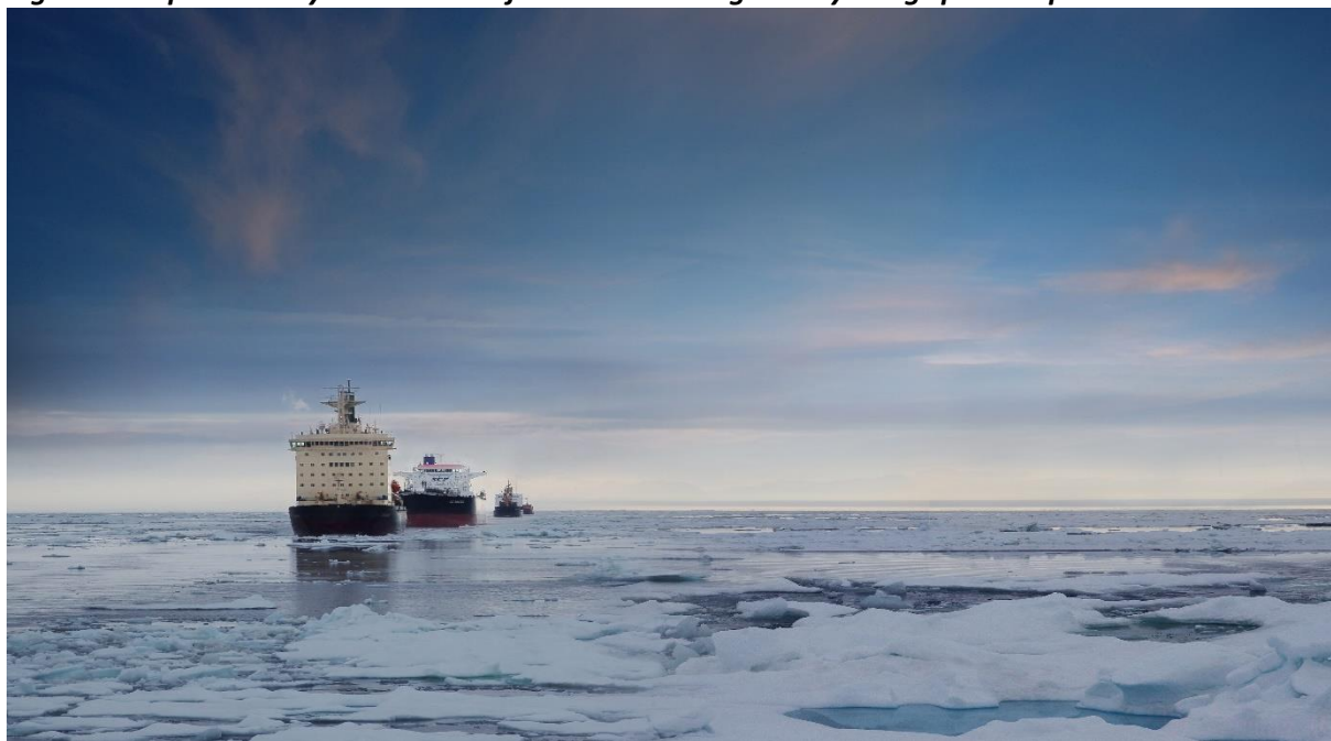
Figur 5 – Skip med isbryterassistanse forserer strekning med tynn og spredt is på NSR
