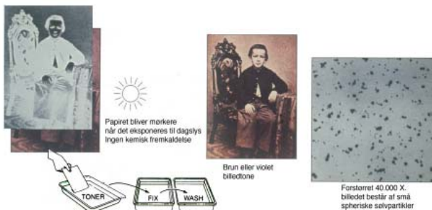
Fig. 6. Fremstillingsproces for POP.
