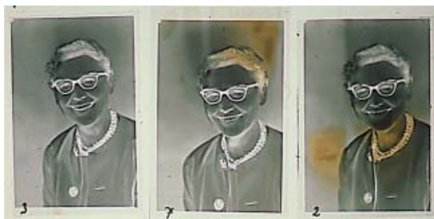
Fig. 26. Nitratnegativer i forskellige stadier af nedbrydning.
