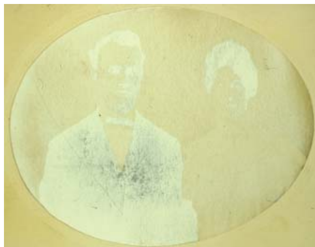
Fig. 12. Samme billed i reflekteret lys, så man ser sølvspejlet.
