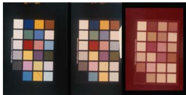
Fig. 15. Kunstigt udbleget farve billed ved 90°C og 60% RF, fra venstre reference, i midten 2 uger og til højre 12 uger.
