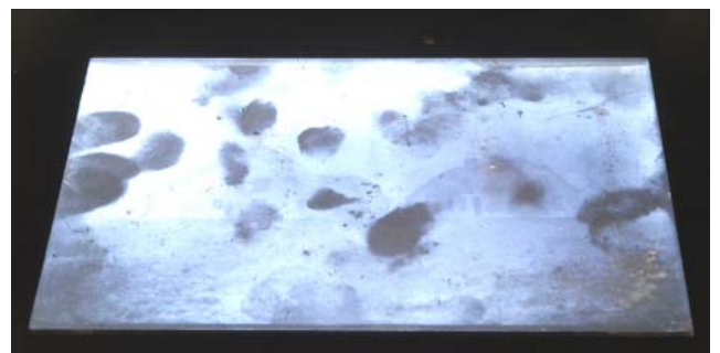
Fig. 5. 13x18 cm, glaspladenegativ med fingeraftryk.
