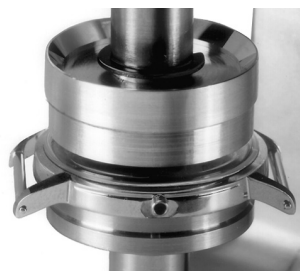
Pose d'un verre avec bague de tension Einsetzen eines Glases mit Spannring Fitting of a crystal with tension ring Colocación de un cristal con aro de tensión
