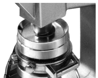
Pose d'un verre avec bague de tension Einsetzen eines Glases mit Spannring Fitting of a crystal with tension ring Colocación de un cristal con aro de tensión
