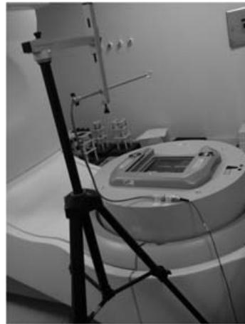
Con el brazo a 180° y manteniendo constante la distancia fuente cámara se interpone la mesa en el haz y se realiza la lectura de la carga recogida por la cámara en ambas condiciones. Se realizan las correcciones de presión y temperatura. Los resultados se muestran en la siguiente tabla:
