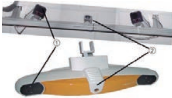
Figura 2. Posición de las cámaras de IR (1) y de vídeo (2). Cortesía de BrainLAB.
