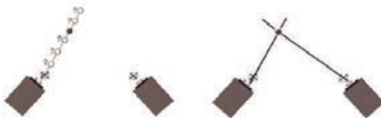
Figura 6. La cámara de la izquierda detecta las posibles posiciones del marcador pero sólo a lo largo de una línea. La información aportada por la cámara de la derecha determina la posición espacial única del marcador. Cortesía de BrainLab.
