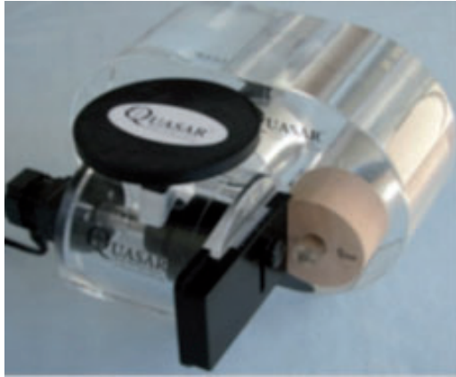
Figura 6. Maniquí para la verificación del movimiento respiratorio marca QUASAR. De material acrílico y dimensiones 60 cm x 30 cm x 12 cm, con insertos para cámara de ionización y detectores tipo MOSFET, y también para películas. Simula un movimiento sinusoidal con una frecuencia entre 4 y 50 ciclos por minuto y rango de amplitud de 0 a 4 cm. Cortesía de Dextro Médica.
