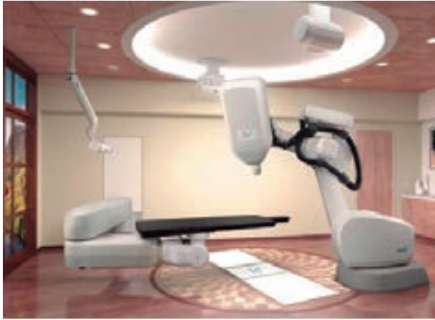
Figura 4. Posición de los tubos de RX y de los detectores respecto a CYBERKNIFE. Cortesía de ACCURAY.
