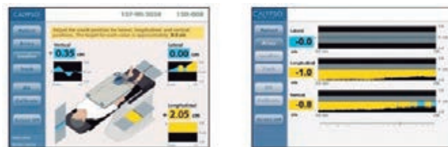
Figura 5. Ejemplo del software del sistema Calypso. En la imagen de la izquierda se representan las desviaciones en la posición de la mesa, detectadas por el equipo. En la imagen de la derecha un registro continuo dentro de la banda de tolerancia. Cortesía de VARIAN Medical Systems.
