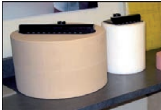
Figura 25. Maniqué de material homogéneo de dos diámetros diferentes, utilizados en la calibración de la normalización del sistema OBI CBCT de VARIAN. Cortesía de ICO-SFMPR
