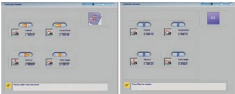
Figura 13. Colocación del maniquí de calibración de los tubos de RX. En la parte izquierda de la imagen la aplicación indica los desplazamientos y rotación de la mesa necesarios para situar el maniquí en la posición correcta. En la parte derecha indicaciones de la correcta posición del maniquí. Datos de IOT.
