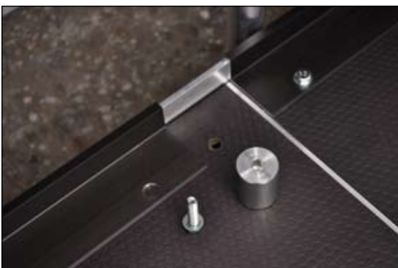
Stoßboard anschrauben Verbindungsstück einschieben evtl. Adapter einsetzen
