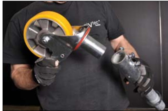
Rolle in Verlängerungsadapter einstecken und sichern
