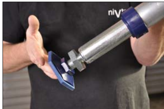
nivellieren Kontermutter festziehen
