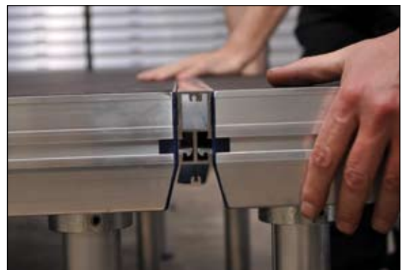
Adapterleiste einsetzen Alternativ: Treppenpodest drehen (Nut hinten)
