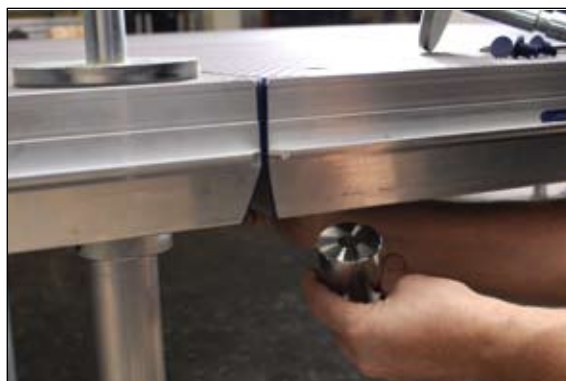
Detail: Adapter in Fußaufnahme einstecken und sichern
