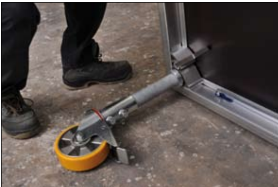
in Fußaufnahme einstecken und sichern
