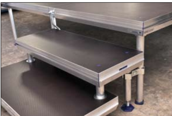
Verbindung von Treppe und Bühne (Nutseite): 1 Fuß-Verbinder 110 mm + 1 Verbinder N-F oder 2 Verbinder N-F
