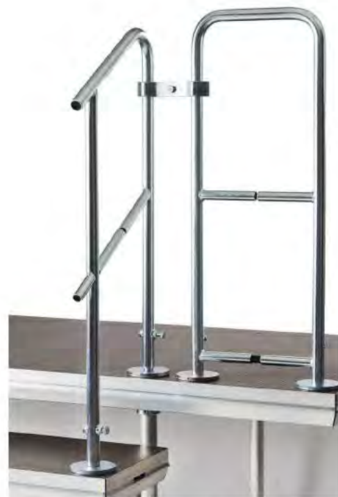
Treppegeländer, Endstück 350 mm – auf Bühne endend Verbindung mit Standard-Bühnengeländer im Raster 35/85/135/185 cm = Verzicht auf Sondermaße 50 / 100 / 150 cm
