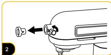
Відкрутіть кріпильний шуруп, який кріпить гнізда насадок, і зніміть заглушку.
