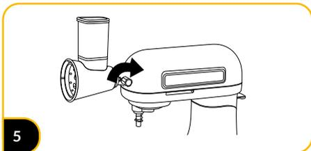
5 Затягніть кріпильний гвинт адаптера
