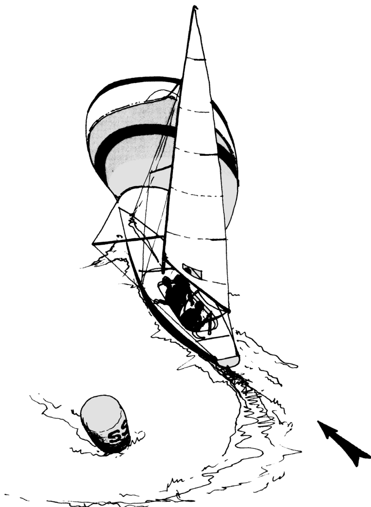
9.6. Spiler "Jibe set" Noter at spilerstagen er sat til bagbord, med spileren fyldt til styrbord som bommen når midten.
