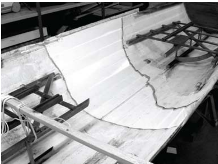
Det nye midterstykke blev samlet med vragets hæk og stævn til en "ny" båd.
