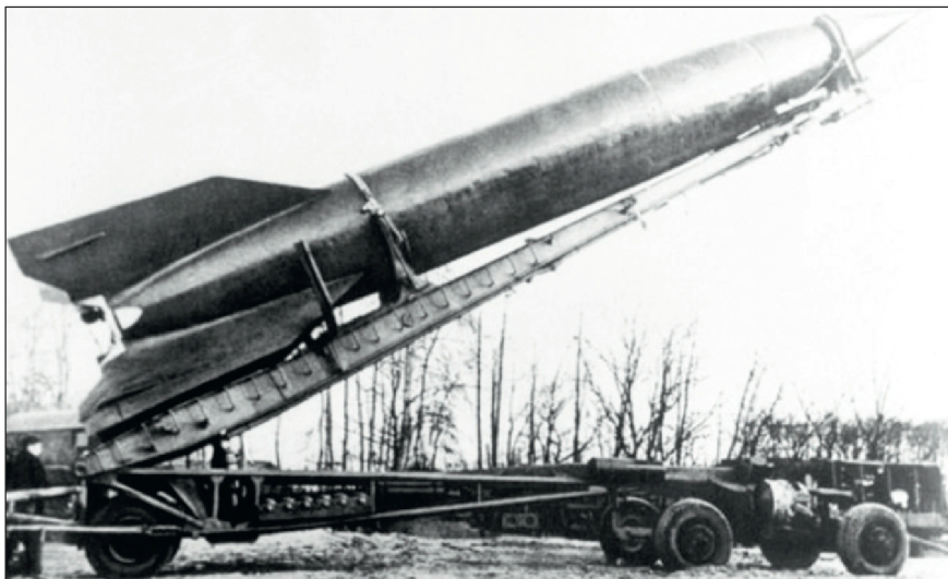
6) En V-2 på en Meilerwagen , som både transporterade och reste roboten. Alla delar av ett V-2 batteri var fordonsburna, och de enda permanenta installationer som krävdes var en väg och en hårdgjord yta stor nog att resa roboten på.
