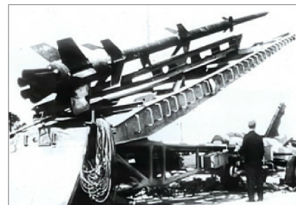
En Rheinbote -raket på sin startramp. Startrampen var en modifierad V-2 Meilerwagen . Rheinbote var en helt ostyrd ballistisk raket och skottvidden bestämdes av i vilken elevation den sköts iväg.
