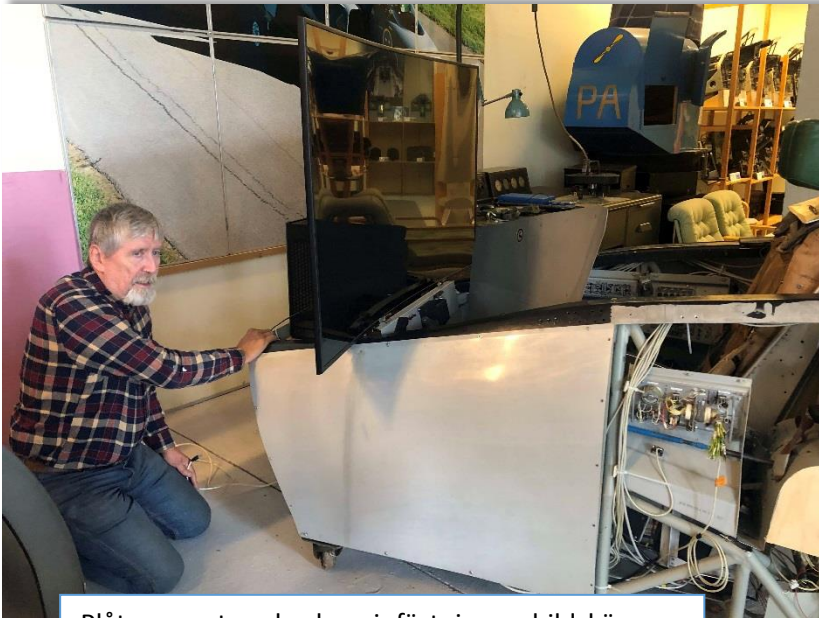
Plåten monterad och ny infästning av bildskärm.
