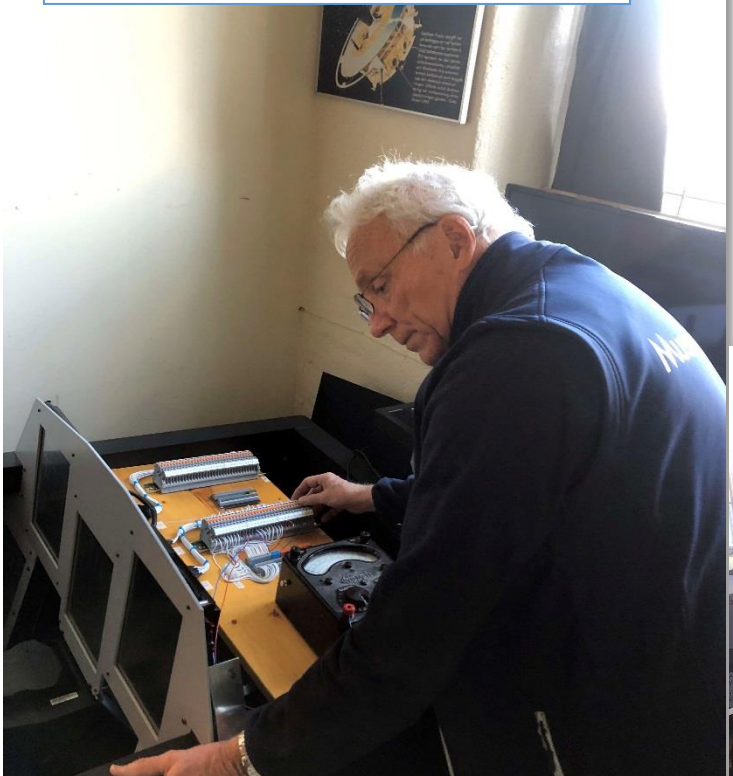
Lars-Erik har satt dit den ny kopplade brädan med plintar och BUX i VR-flygsimulatorens
