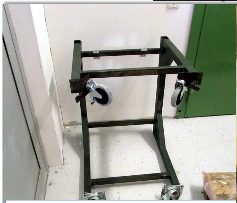
Stativet till GT3 motor måste förstärkas för att klara vikten.
