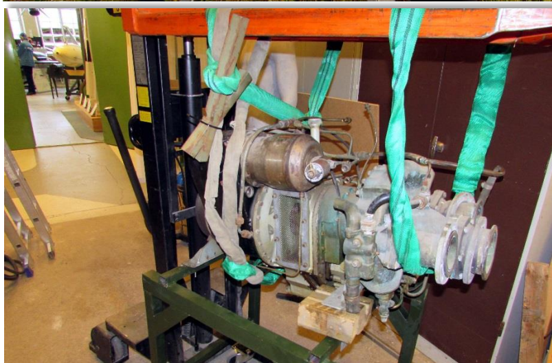
Motor GT3 hänger i lyften för monteras i ett stativ.
