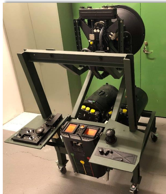
Radar PS42 till J32B Lansen monterad på stativ med övriga ingående detaljer till en komplett enhet.
