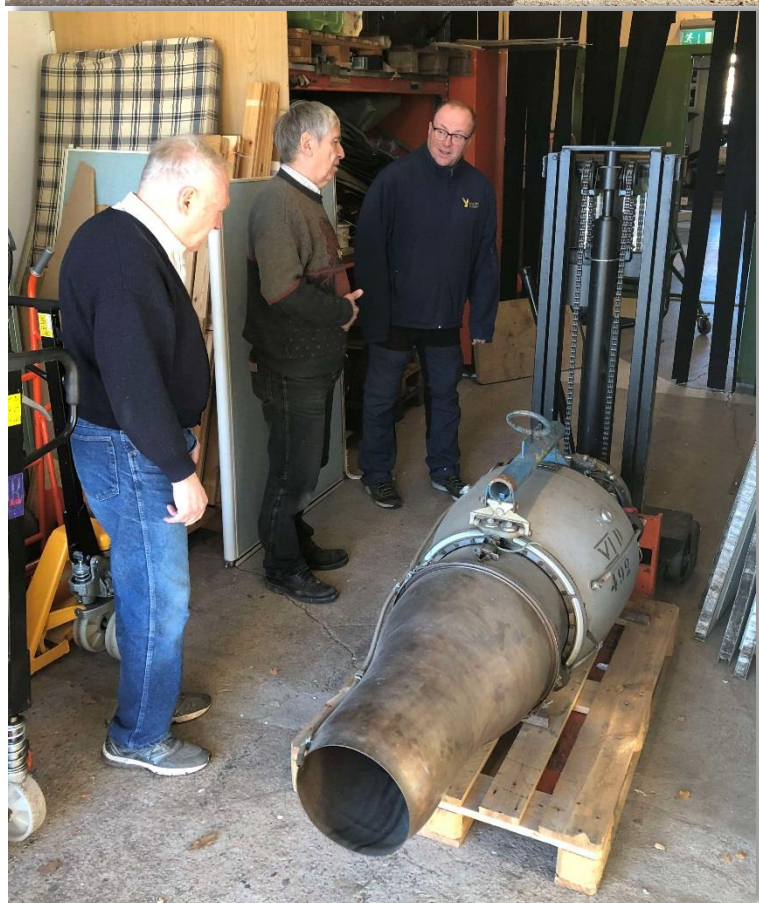
Det är en RB08 motor. Turbomeca 400 Kp.
