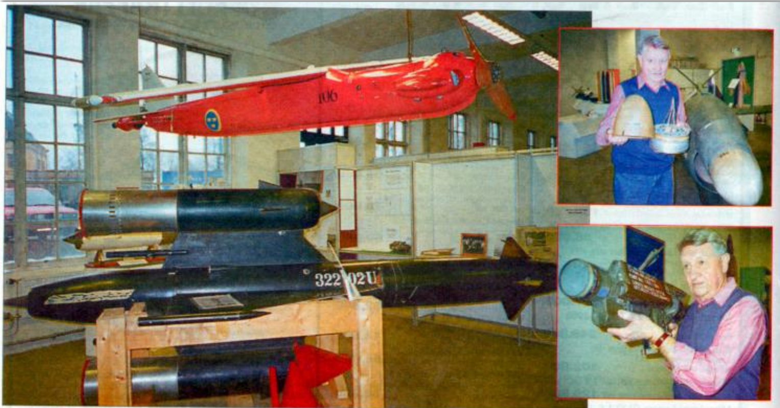
Den röda målroboten Humian, från 1960-70-talet hänger i taket. Den sköts upp med raket och drevs i luften av en bilmotor. Är propellerdriven och radiostyrd från marken. Den användes som målrobot för marinens räkning. Längre ner på bilden ser vi luftvärnsroboten 322. Lilla bilden överst: Den drygt sju meter långa Robot 08, den största i samlingen, är en sjö- och kustrobot. I händerna håller Stig Jäderlund robotens radarmålsökare. Lilla bilden längst ner: Jäderlund demonstrerar Robot 69, Red eye – en barbar luftvärnsrobot.
