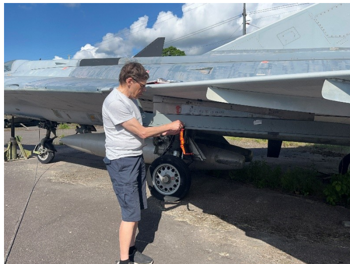
260608 Markko sätter dit låsvredet innan hängningen av Rb24J
