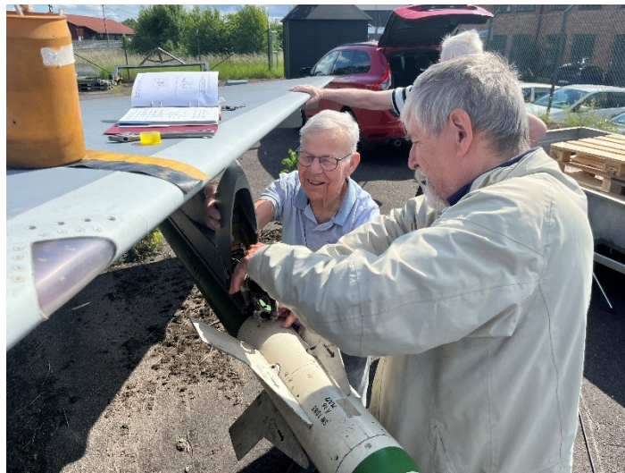
260608 Håkan H och Stefan kopplar in anslutningen till målsökarenheten i robotskenan
