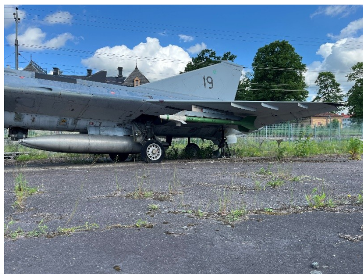
260608 Äntligen är 350E beväpnad med en Rb24J under vänstra vingen, men det saknas en Rb24J på höger sida
