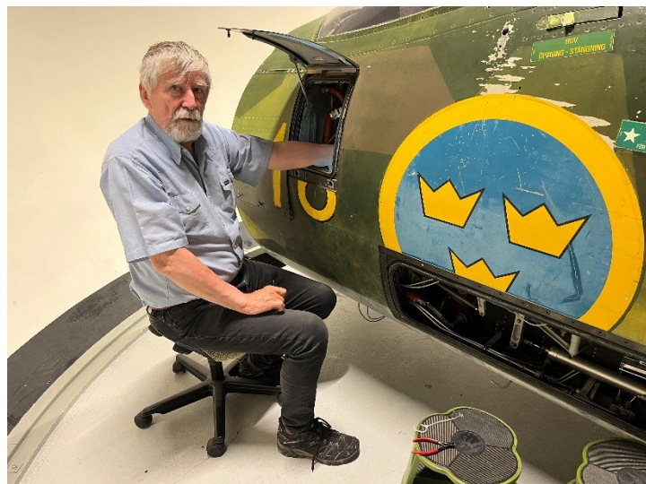
260623 Stefan byter vänster bromsgivare på JA37C-sim
