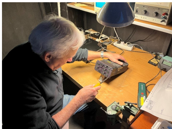
260914 Lars-Erik börjar ta isär JA37C Datapanel för att tända upp lampinformation i enheten
