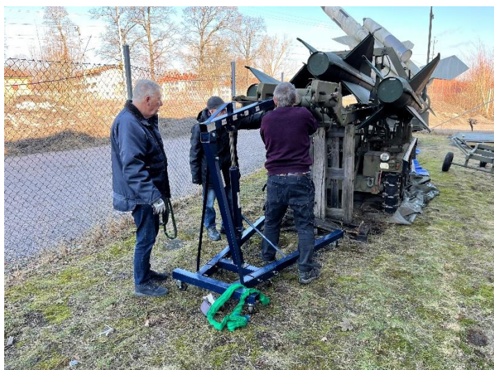
Stefan, Anders och Mats förbereder lyft av Rb77 för borttagning av den ruttna stående SJ-pallen.
